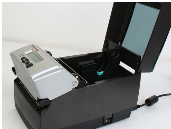
Figura 2-20. Sollevamento della Copertura Anti-polvere
